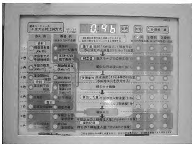
図4 開発中の日射比例型量的管理用コンピュータ 比較的小規模施設用で、各種制御モードを備える。
