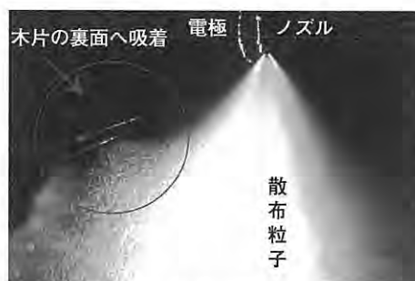
図2 静電散布した粒子の挙動(コロナ帯電方式)
