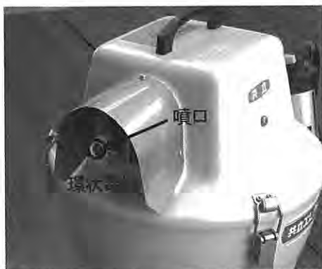
図4 静電散布装置の電極とノズル噴口
